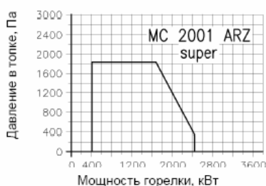
Arbeitsfeld nach/working-diagramm after DIN-EN 676
