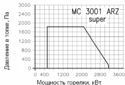
Arbeitsfeld nach/working-diagramm after DIN-EN 676
