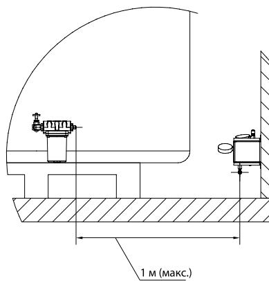
**Важно :** Забор топлива должен осуществляться на расстоянии не менее 150 мм от дна топливного бака, чтобы предотвратить всасывание осадка. Топливная емкость должна быть надежно зафиксирована на бетонном либо металлическом основании, смещения емкости не допустимы. Обслуживание топливной емкости должно проводиться регулярно (слив отстой), чтобы исключить накапливание осадка.
