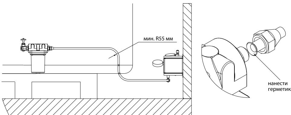
**примечание:** Пункты 3 и 4 не обязательно выполнять в приведенной последовательности. Можно сначала развалицевать и присоединить один конец медной трубы, затем придать трубке нужную форму, а после отрезать ее от бухты. Перед вальцовкой не забывайте надевать конусные гайки!
