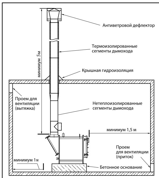
рис. 7 Пример установки дымохода через крышу (перекрытие)
