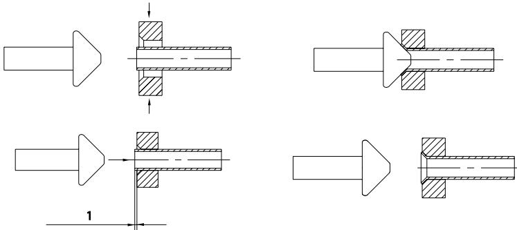
**внимание:** Используйте ТОЛЬКО медную кондиционерную трубу размером 3/8". Не забудьте перед вальцеванием надеть гайку. При присоединении медной трубы к штуцерам необходимо развалицевать концы этой трубы специальным инструментом. Внутренняя поверхность конуса (45°) должна быть ровной, без задиров, чтобы обеспечить герметичность соединения. Не используйте обжимные фитинги. Не используйте лён или тефлоновую ленту (фум) для уплотнения соединений.
